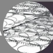
As **MOLAS BONNEL** são interligadas entre si por arames, proporcionam muita maciez e estabilidade no molejo. A mola Bonnel possui um formato bicônico e é fabricada com fio de aço e temperado com alto teor de carbono.
